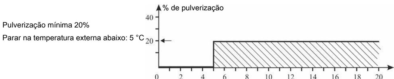
Figura 30: Pulverização de acordo com a temperatura externa
