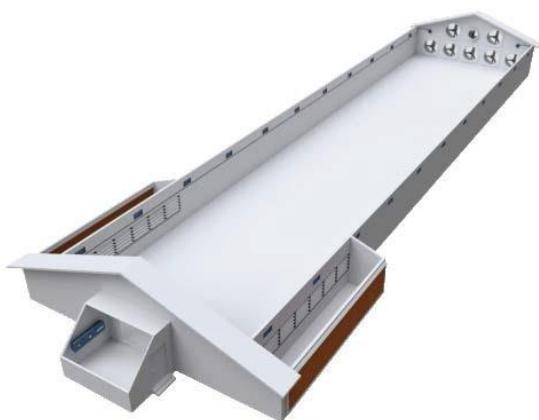
Os galpões com sistema de túnel de ventilação são destinados a regiões tropicais, onde é constantemente quente, e, portanto, é necessário diminuir a temperatura no local.
