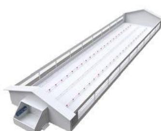
Usando ventilação natural, a troca de ar ocorre quando as correntes de ar se movem entre a entrada de ar ajustável e a saída de ar sem qualquer assistência de ventiladores.
